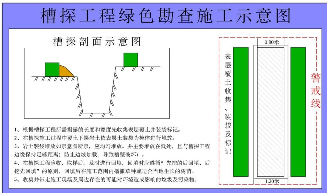
图 8-2 槽探工程绿色勘查施工示意图牌
