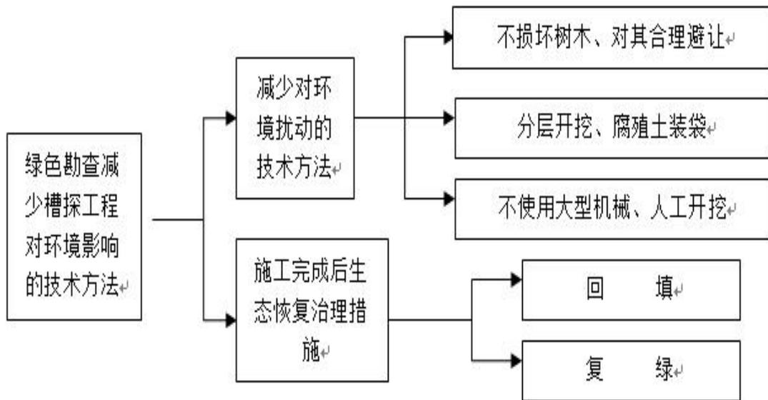
图 8-1 槽探施工技术体系框架图
